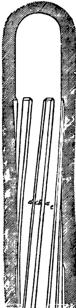
Fig. 22. — Sezione di un cannone rigato italiano.
